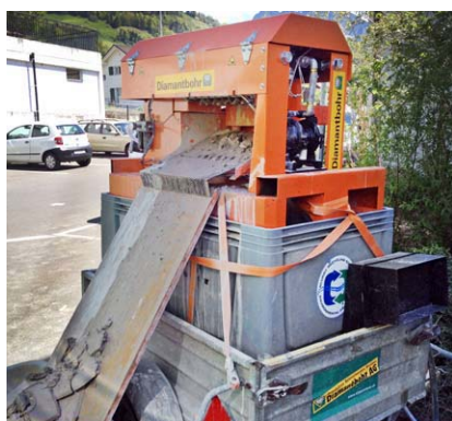
Einsatz der Schlammpresse bei Schulhaus-Umbau
